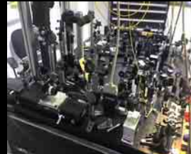
Système combinant optique adaptative et OCT à l'Université de Cardiff
